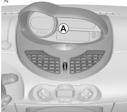
Quadro della strumentazione A
