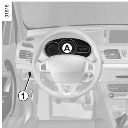
**Quadro della strumentazione A:** si accende all'inserimento del contatto. È possibile regolarne l'intensità d'illuminazione ruotando la rotellina zigrinata **1**.
